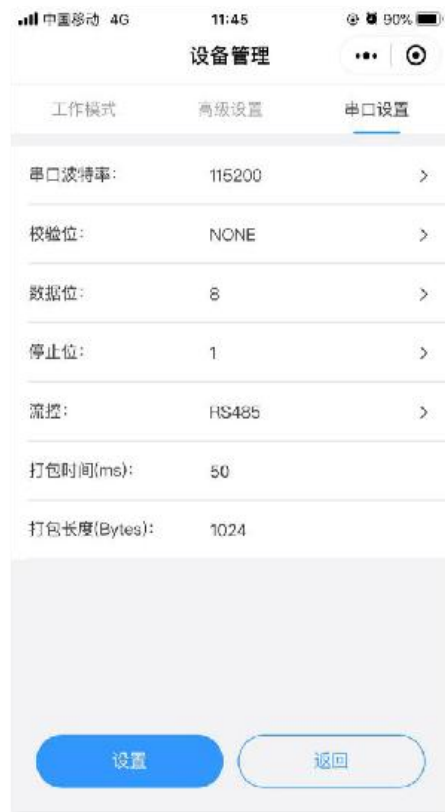
图 45 串口设置界面示意图
