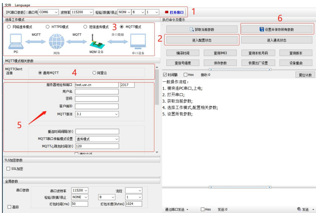
图 2. 设置软件 MQTT 模式示意图
