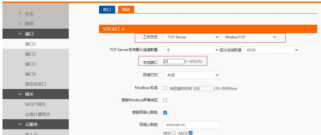
图 61 Modbus RTU 转 Modbus TCP
