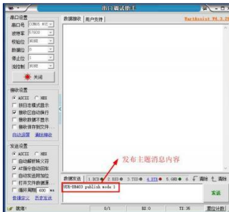
图 81 MQTT 发布模式 1 串口发布数据
