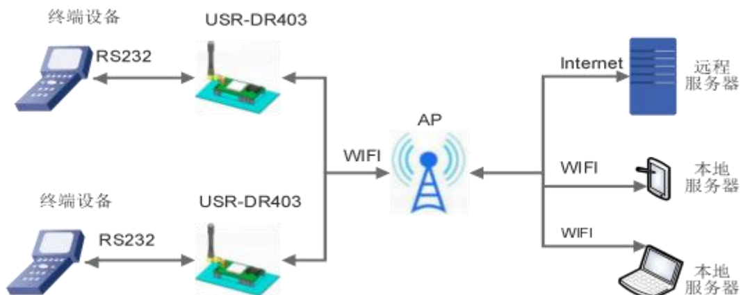
图 26 无线组网应用 (STA)
