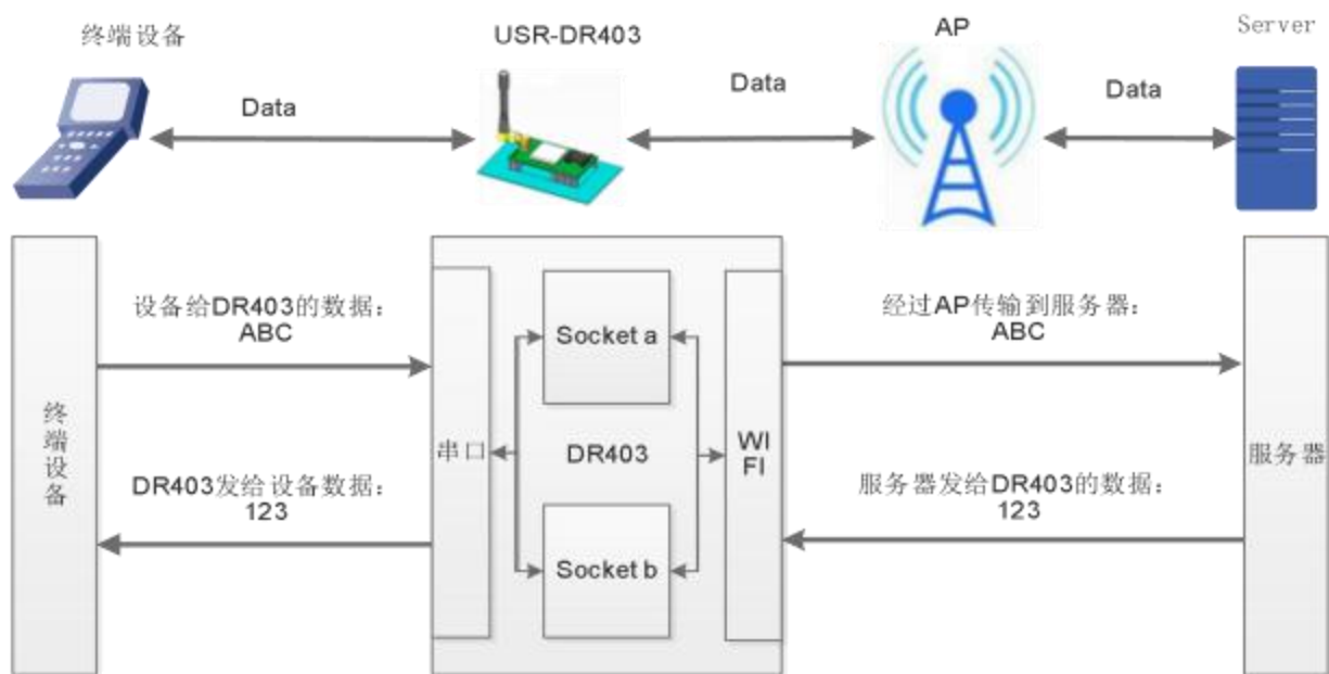
图 37 透明传输功能框图
