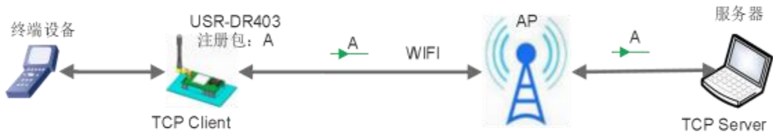
图 52 首次连接发送注册包框图
