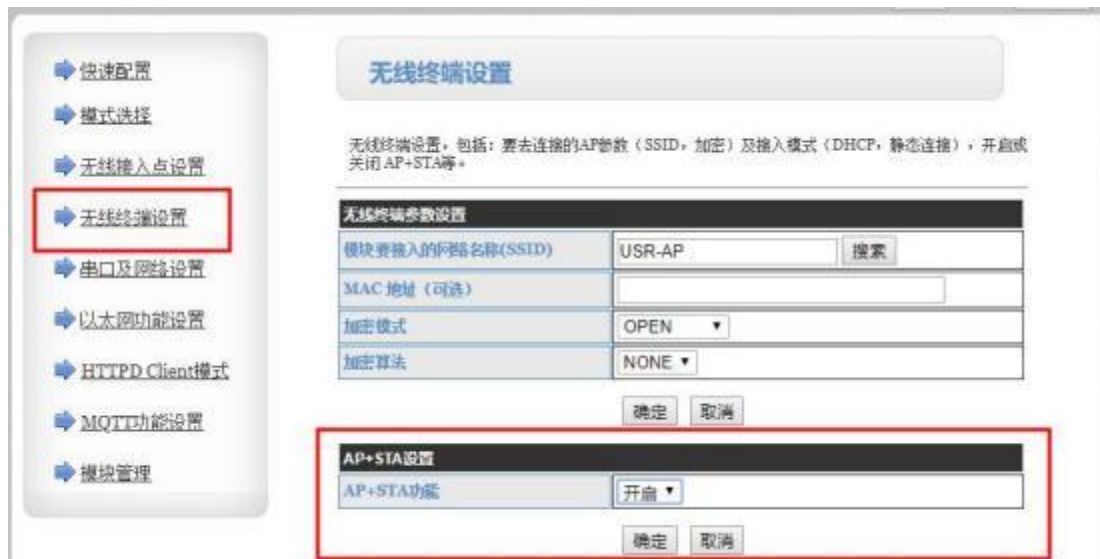
图 28 无线组网应用 ( AP+STA)
