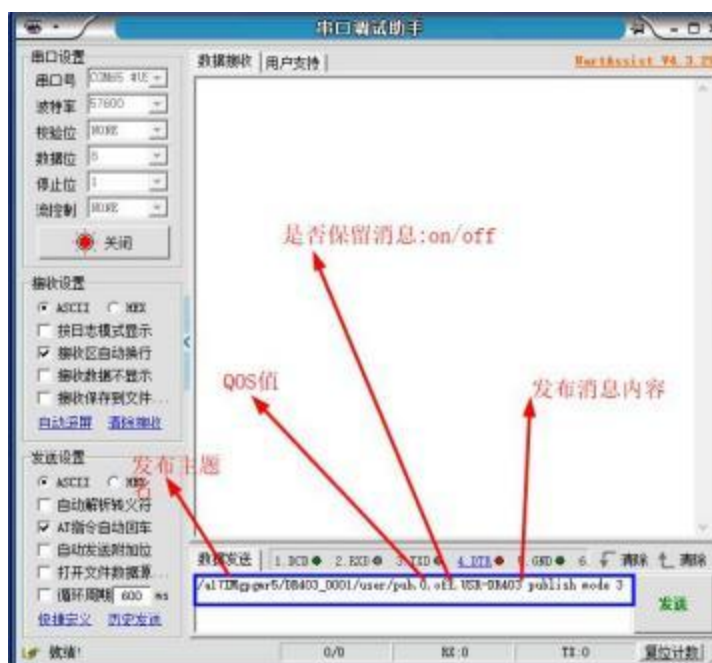
图 87 MQTT 发布模式 3 串口发布数据
