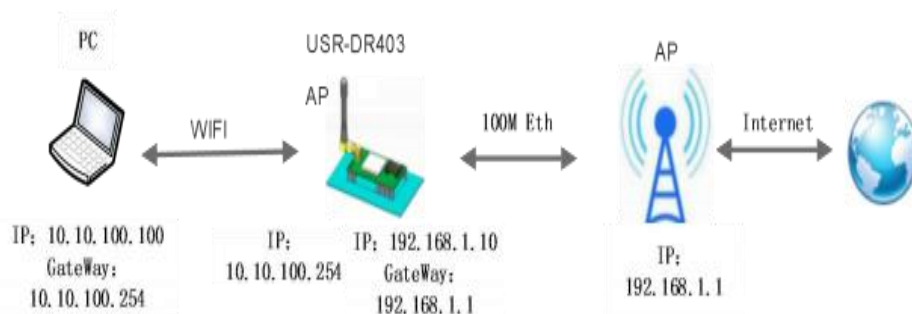
图 32 有线加无线的组网应用 (AP WAN)
