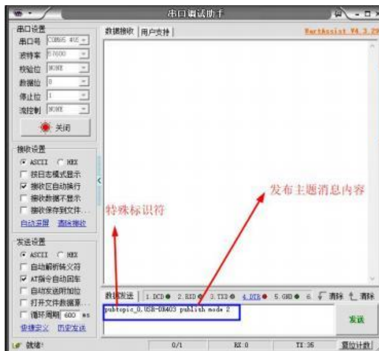
图 84 MQTT 发布模式 2 串口发布数据
