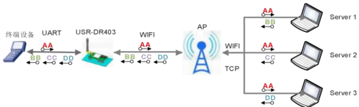
图 46 多 TCP 链接数据传输图示
