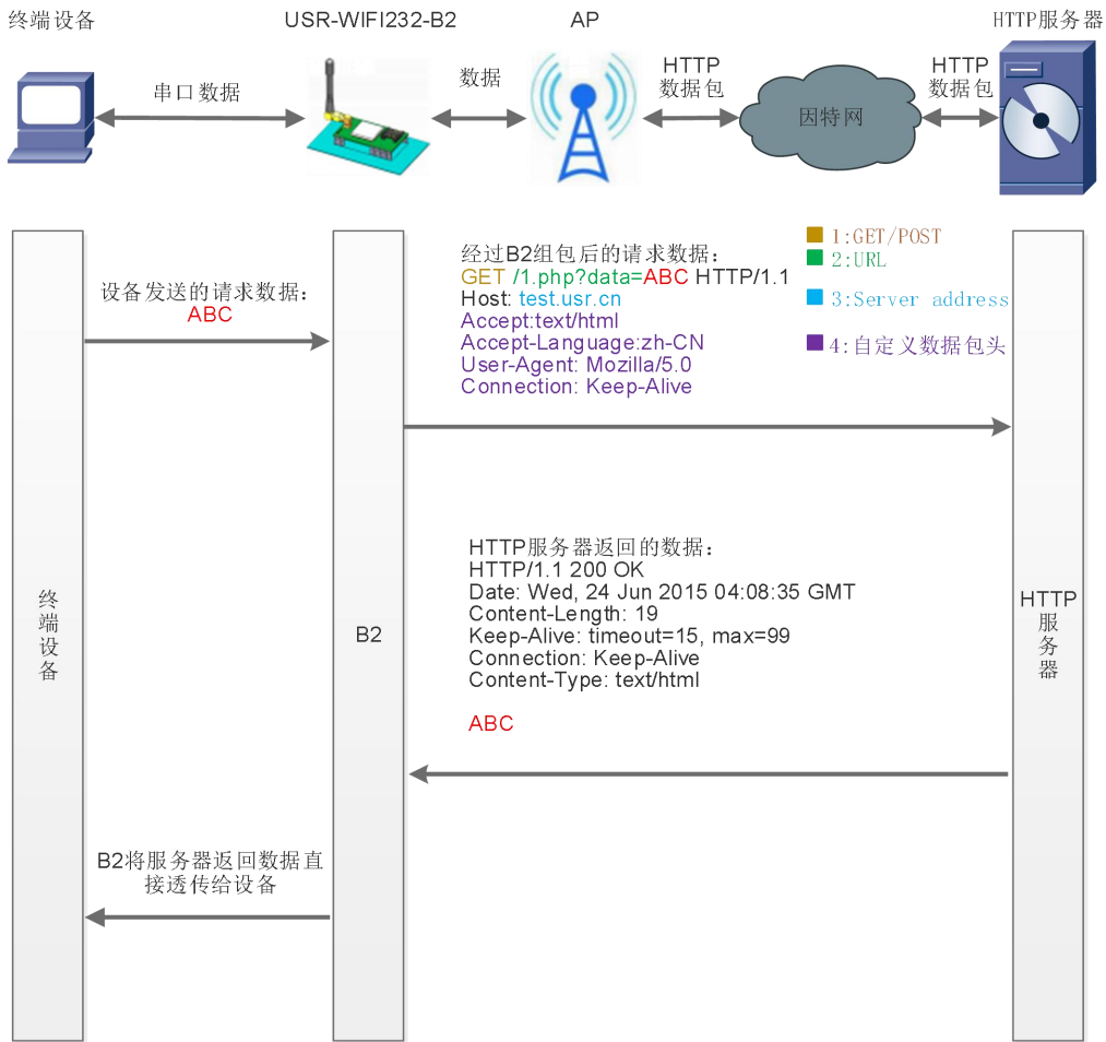
图 24 HTTPD Client 功能框图
